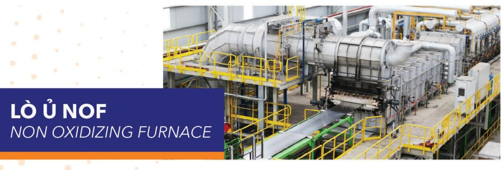
• Thiết bị hiện đại với công nghệ tiên tiến nhất đảm bảo xử lý bề mặt tuyệt đối sạch và cơ tính theo yêu cầu của nguyên liệu đầu vào trước khi đưa vào chảo mạ. Lò ủ NOF bao gồm buồng gia nhiệt trước, tận dụng nhiệt thải, buồng đốt trực tiếp để đốt cháy sạch dầu mỡ và rỉ sét trên băng tôn, buồng đốt gián tiếp để ủ tôn đạt độ cứng theo yêu cầu. Ngoài ra lò còn được trang bị cửa chắn bui kẽm, hệ thống làm ẩm ni-tơ để chống bui lò.
